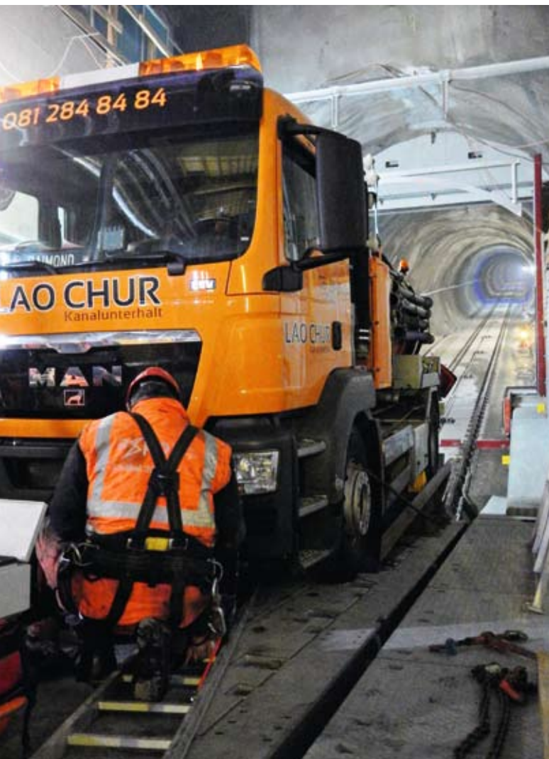
Der Lastwagen wird auf die Standseilbahn verladen.
